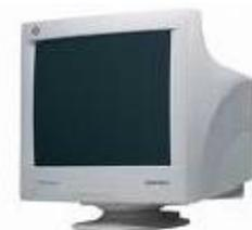
vídeo son las que se visualizarán por pantalla. El monitor incorpora controles típicos de brillo y contraste. El funcionamiento del CRT monocromo consiste en la emisión de un haz de electrones de intensidad variable, deflectado en dos direcciones espaciales perpendiculares entre sí y al haz mediante un campo magnético generado por unas bobinas que rodean al eje del haz.
